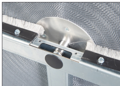
(5) Entfernen Sie die Bürstendichtung und die Lagerabdeckung
