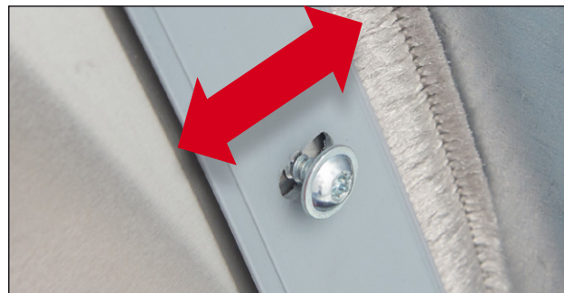
Die Umfangsdichtung ist mittels Langloch am Dichtungsträger auf der Speichermasse verstellbar. Damit kann die Dichtung optimal zwischen Speichermasse und Gehäuse abgedichtet werden.
