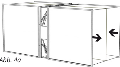
Abb. 4: Montage im Klimagerät. obere Abb. zeigt Luftstromtrennung übereinander
